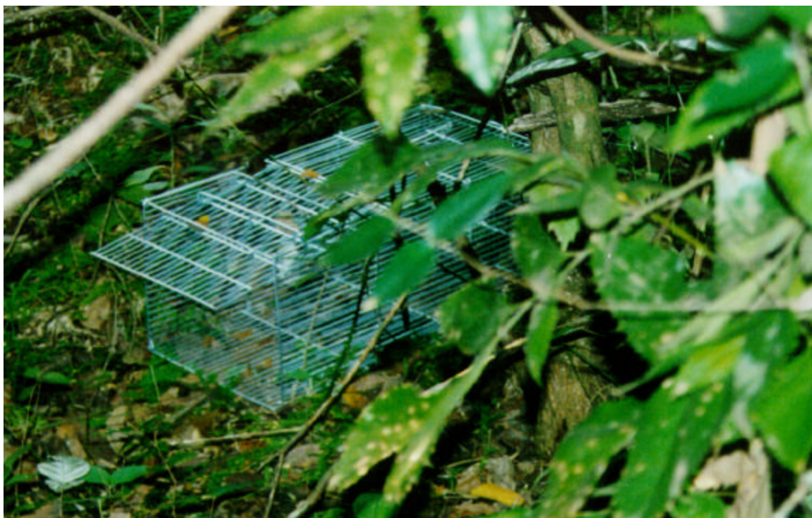
Figura 5 - Armadilha do tipo gaiola de tamanho médio (25x25x40 cm).
