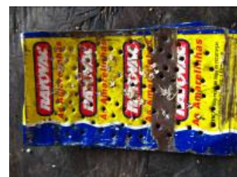
Figura 36. Ralador fabricado com lâminas de pilhas.
